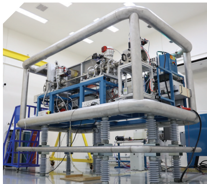
เครื่องยิงลำไอออนพลังงานสูง ระดับอุตสาหกรรม
